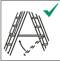
**Verwenden Sie die Leiter nur mit vollständig ausgeklappten Sicherungseinrichtungen.**
