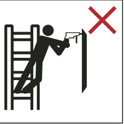
**Vermeiden Sie Arbeiten, die seitliche Belastungen auf die Leiter ausüben, z. B. seitliches Bohren in harte Materialien.**
