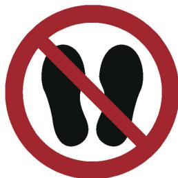
**Jede horizontale Fläche auf der Leiter, die wie eine Plattform aussieht, aber nicht zum Stehen gedacht ist (z. B. eine Kunststoff-Werkzeugablage), muss deutlich gekennzeichnet sein (nur falls durch die Konstruktion notwendig).**
