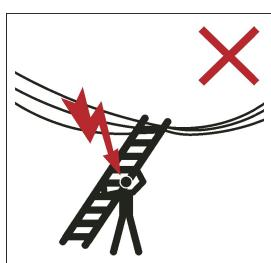
**Achtung – Stromschlaggefahr: Identifizieren Sie elektrische Gefahren im Arbeitsbereich, z. B. Stromleitungen oder freiliegende elektrische Geräte. Verwenden Sie die Leiter nicht, wenn Stromschlagrisiken bestehen.**
